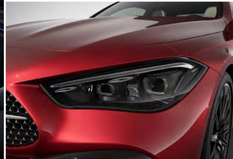
DIGITAL LIGHT mit Projektionsfunktion (PAX) und Adaptiver Fernlicht-Assistent Plus (628)
