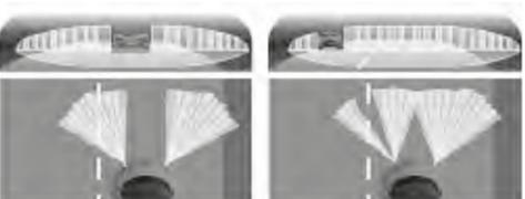
Deaktivierung einzelner LEDs, damit vorausfahrendes Fahrzeug nicht geblendet wird. Deaktivierung einzelner LEDs, damit entgegenkommendes Fahrzeug nicht geblendet wird.
