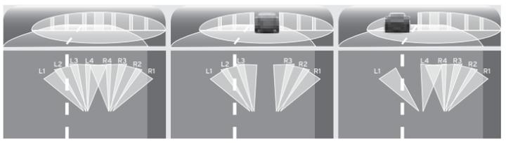
Fernlicht schaltet sich ein. Deaktivierung einzelner LEDs, damit vorausfahrendes Fahrzeug nicht geblendet wird. Deaktivierung einzelner LEDs, damit entgegenkommendes Fahrzeug nicht geblendet wird.
